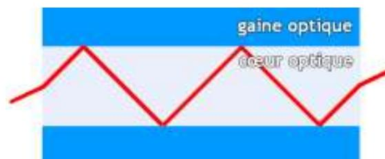
Physiquement, plus la fréquence d'un signal est élevée, plus il peut transporter d'informations par unité de temps. Les longueurs d'onde de la lumière étant beaucoup plus courtes que celles des ondes radio ou des ondes électromagnétiques, les débits permis sont donc beaucoup plus importants. Les distances possibles sont également plus élevées (plusieurs dizaines de kilomètres), en raison de phénomènes d'atténuation moins marqués.
